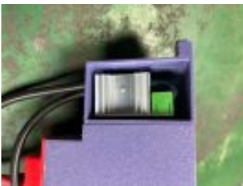
📷 Photo 21 – Module de variation de vitesse
