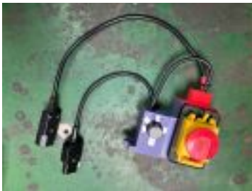
📷 Photo 20 – Ajout d'un variateur de vitesse + sécurité
